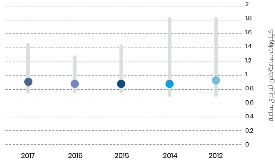
الشكل 6: الكفاءة الكهربائية لمحطات تبريد المناطق
